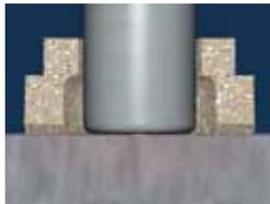
Der Bolzen wird auf das Werkstück aufgesetzt.
