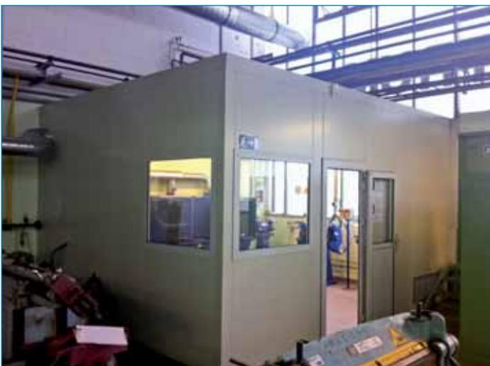
Beispiel für die Aufstellung einer Kabine im Arbeitsbereich einer großen Halle zur Reduzierung des Lärms bei Schleifarbeiten.
