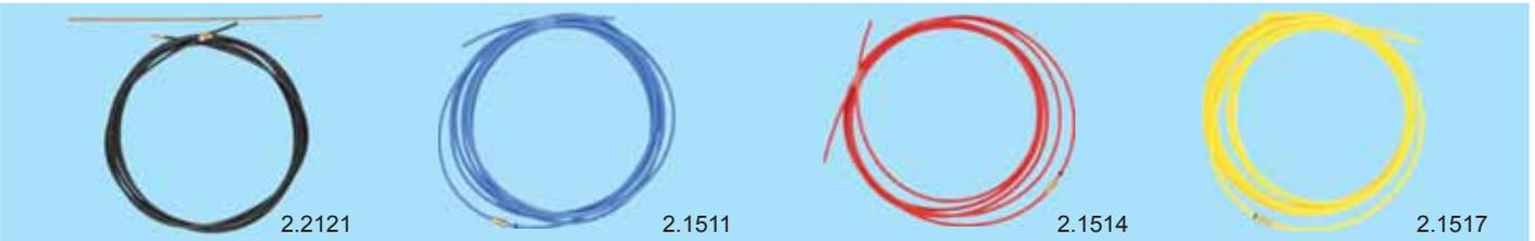
Ebenfalls lieferbar: CeraGlide PTFE-Keramikseelen - Wir empfehlen diese Seelen, wenn mit herkömmlichen Drahtführungen Probleme auftreten, z.B. beim Schweißen mit dünnen Aluminium-Drähten oder mit langen Schlauchpaketen.
