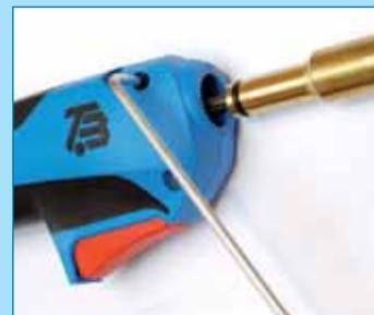
Der XP-Hals kann zur optimalen Anpassung an die Schweißaufgabe in jeder beliebigen Richtung fixiert und sekundenschnell ohne Öffnen der Griffschale getauscht werden.
