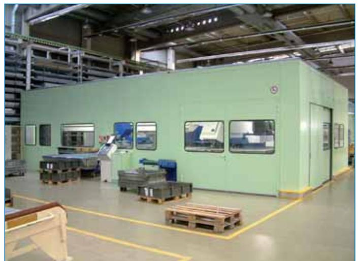
Komplette Einhausung einer Stanzmaschine mit einer Schiebetür auf der rechten Seite und unterschiedlichen Türen auf der Vorderseite.
